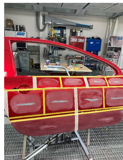
Panneau-test après ponçage des dommages
