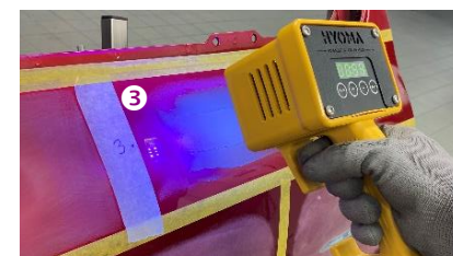
Exemple séchage mastic : lampe Iwata sur un des dommages n°3
