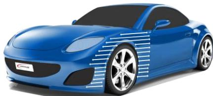
2. Applicare la **tinta in Hydrofan** a copertura (parte nuova). Lasciare opacizzare completamente la superficie prima di proseguire.
