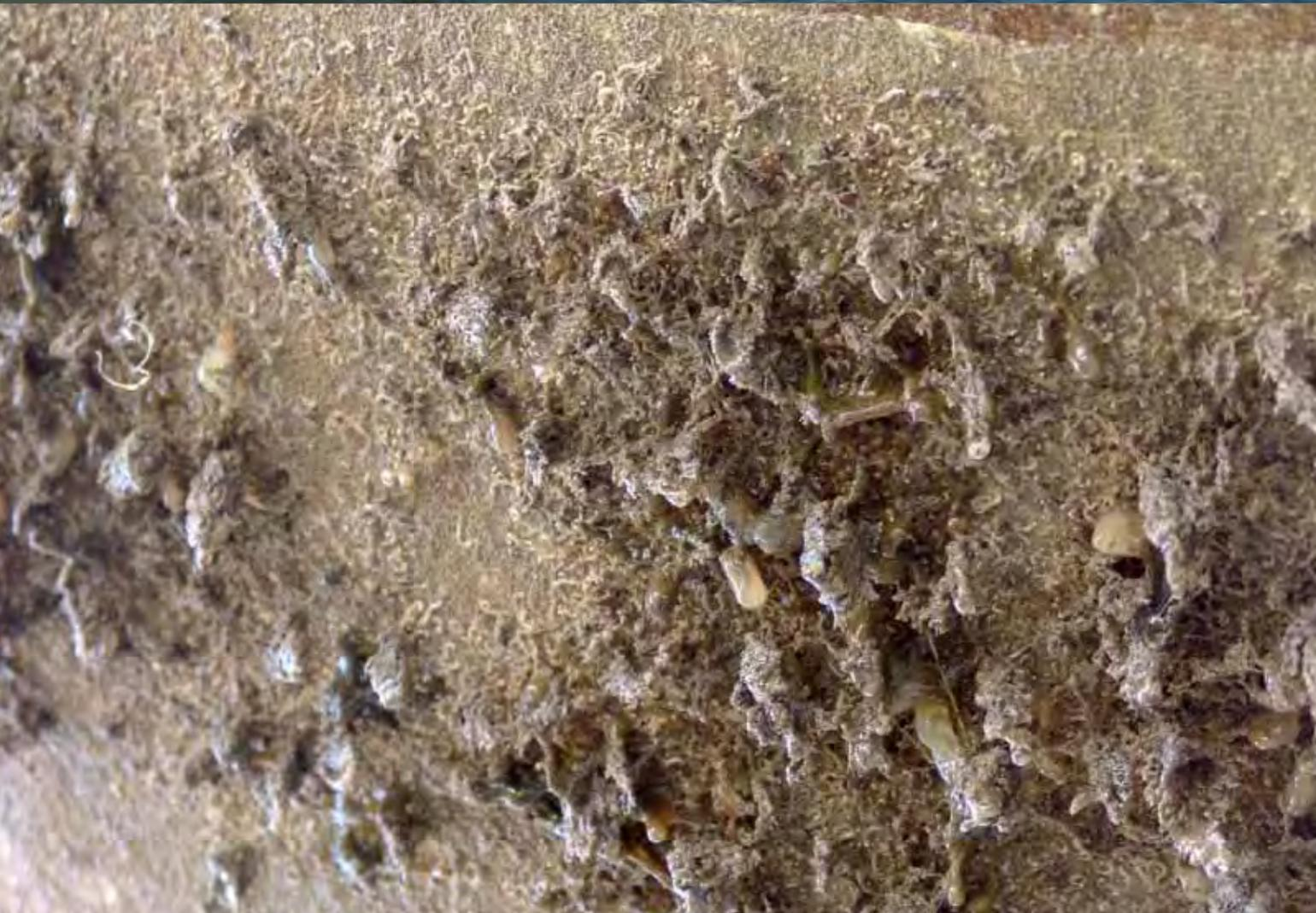
L'antivegetativa è un rivestimento di vernice che viene applicato sulla parte immersa delle imbarcazioni (opera viva) per difenderla dall'insediamento del fouling (incrostazioni).
