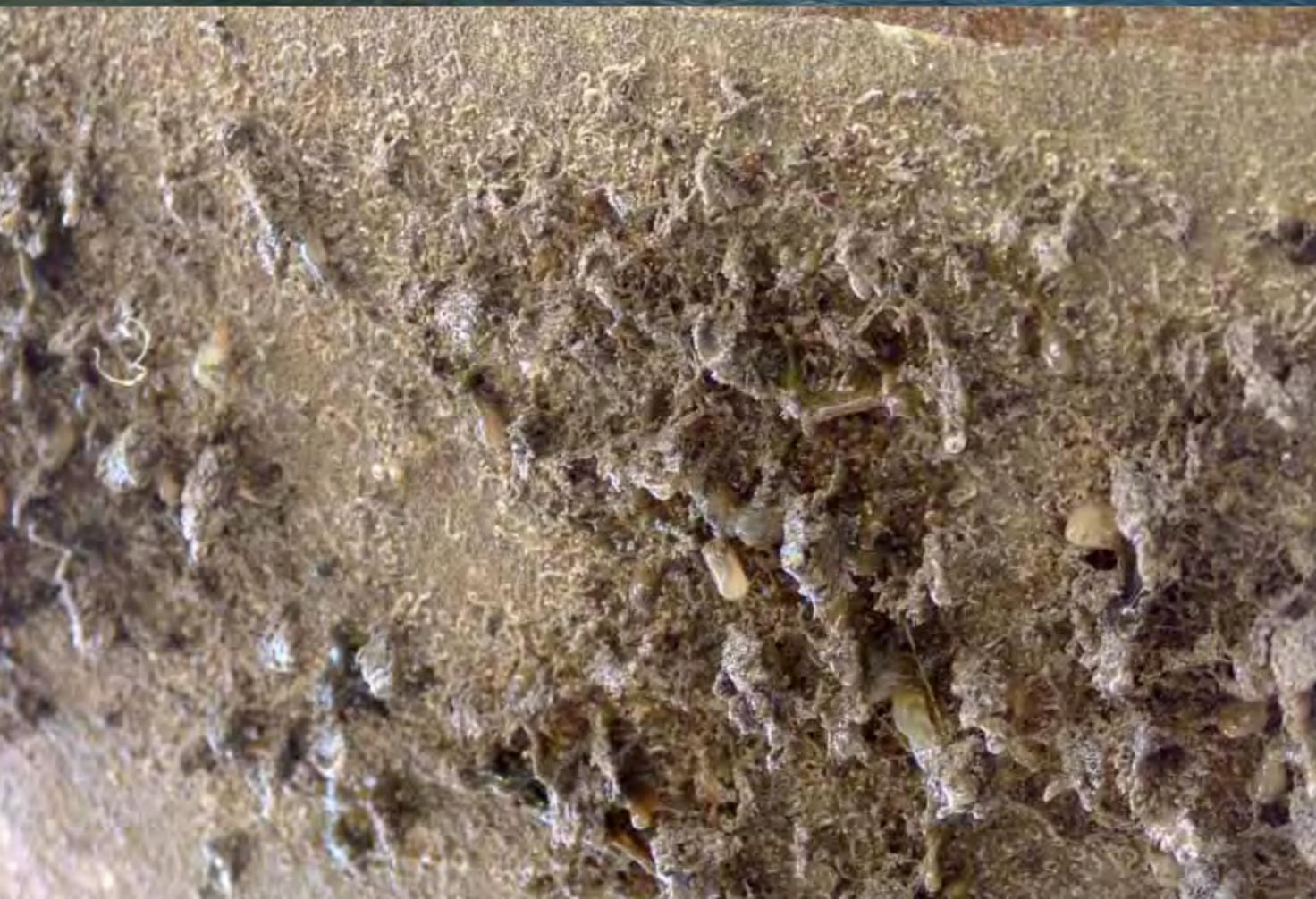
L'antivegetativa è un rivestimento di vernice che viene applicato sulla parte immersa delle imbarcazioni (opera viva) per difenderla dall'insediamento del fouling (incrostazioni).
